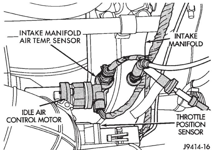
Fig. 30 Sensor—2.5L Engine
